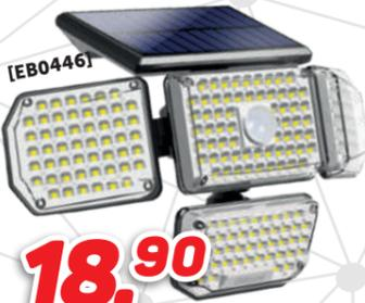
430 Lumens. 6500K Luz Fría. Batería 3.7V, 1200mah. Ángulo iluminación hasta 360°. Panel solar integrado: 5.5V, 1.5W. IP44. Sensor de movimiento de 3 - 5 metros. Altura de instalación recomendada hasta 3 metros. Tiempo de carga: 6 - 8 horas aprox. Tiempo de uso: 6 horas aprox. 3 modos de trabajo: Siempre encendido cuando no hay luz. Siempre encendido con luz tenue. Cuando detecta movimiento se enciende por completo. Se enciende solo cuando detecta movimiento.
